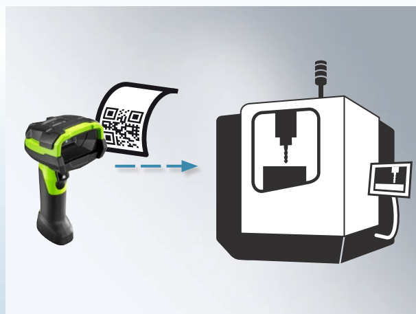
Das an der Maschinensteuerung angeschlossene HQR-System liest den QR-Code und übermittelt die Werkzeugdaten direkt in die Steuerung der Maschine/The HQR system is connected to the machine control system. It reads the QR code and transmits the tool data directly to the control system
