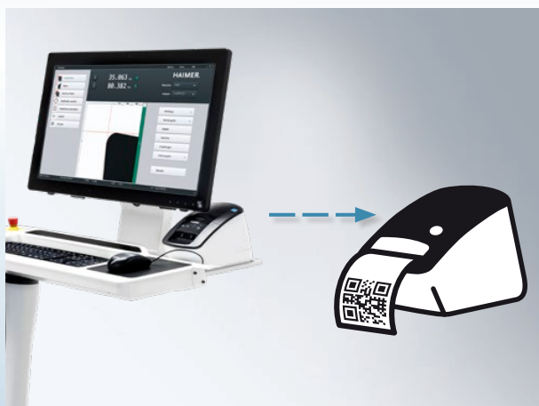
Nach dem Messen des Werkzeuges wird ein Etikett mit QR-Code gedruckt After measuring the tool, a label with the QR code is printed
