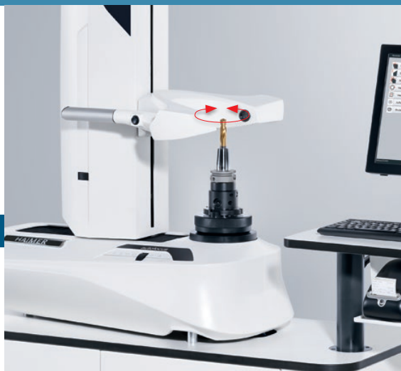
Automatisches Scharfstellen der Schneide Automatic cutting edge focusing
