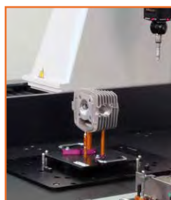
K551218: Aplikace systému spodní upínací palety
