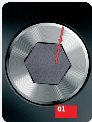
Obr. 01 Běžné nářadí na šrouby s vnitřním šestihranem má liniový kontakt v profilu šroubu, což má za následek silné zařezávání hran.
