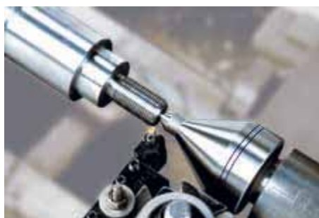
Prodloužení otočného hrotu zaručuje potřebný vnější úhel při soustružení součástek malých průměrů.
