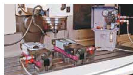
Typ NCH, hydraulicky ovládaný - lze dodat na vyžádání
